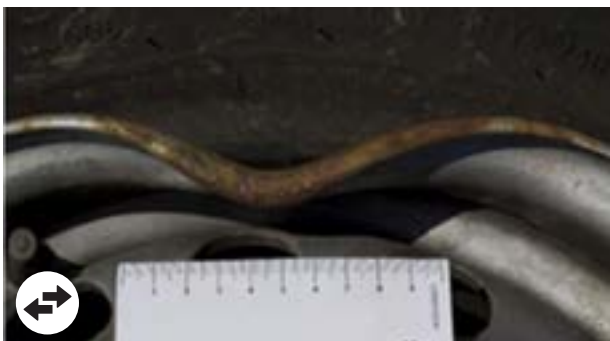
Voile de jante déformé, jante non conforme. Valorisation d'un contrôle de géométrie pour vérifier l'état sécuritaire du véhicule
