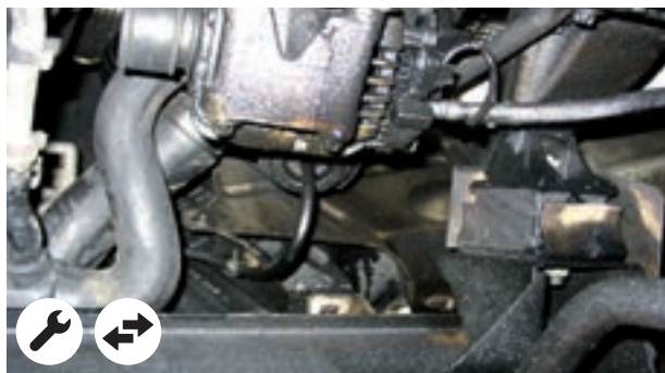
Fuites au niveau du boîtier de direction et de la pompe de direction assistée
