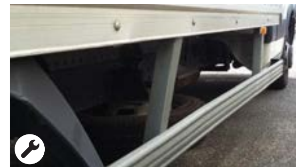
Barres cyclistes: déformation dans la limite économique de la réparation
