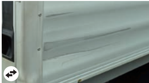
Déformations de ridelles hors limite économique de la réparation , fermeture impossible ou non étanche au sable
