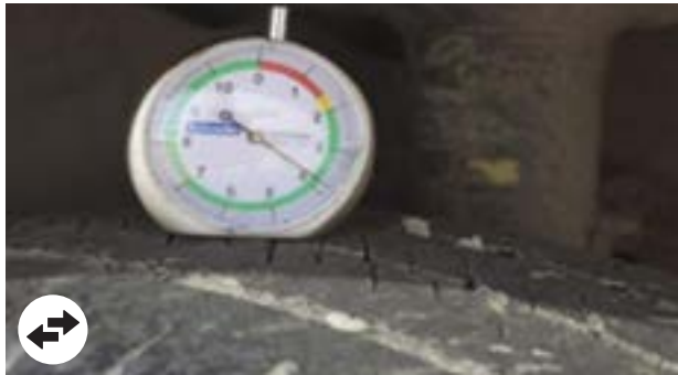
Pneumatiques: profondeur de fond de gorge < 5 mm Nota : La mesure de l'usure des pneumatiques est réalisée dans la rainure la plus usée du pneumatique.
