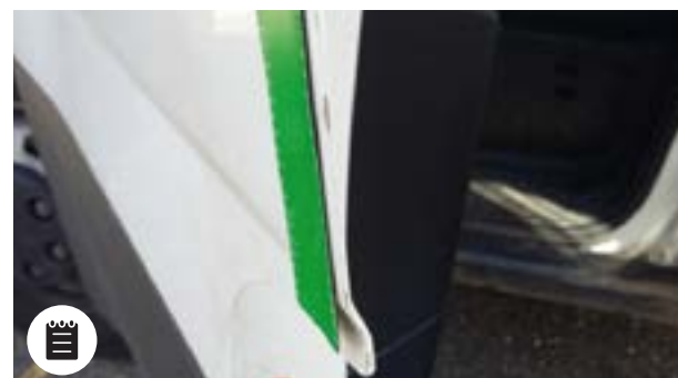
Eclat sur tranche de portes
