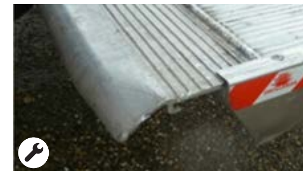
Hayon élévateur: déformations du plateau dans la limite économique de la réparation
