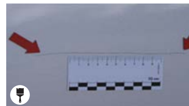
Rayures > 50 mm NB : sur porte battante arrière pas de possibilité de peinture par demi panneau
