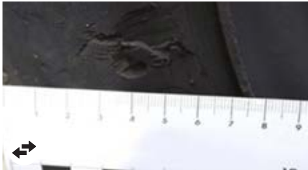
Pneumatiques: entaille > 3 mm de profondeur, arrachement
