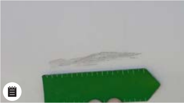
Panneaux latéraux: rayure légère avec arrachement de matière ≤ 20 cm
