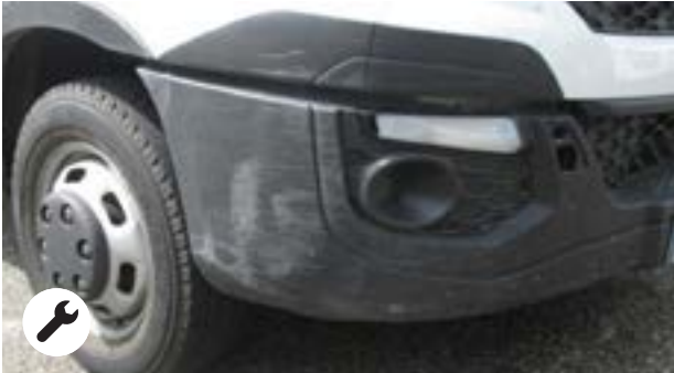
Arrachement de matière ou déformation dans la limite économique ou de faisabilité
