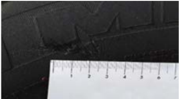
Pneumatiques: entaille ≤ 3 mm de profondeur (CONFORME)
