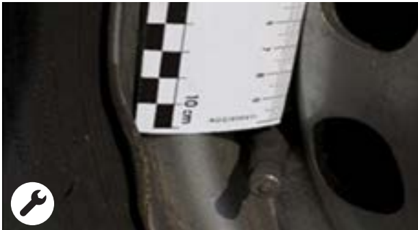
Sur jante acier : bord d'accroche légèrement déformé
