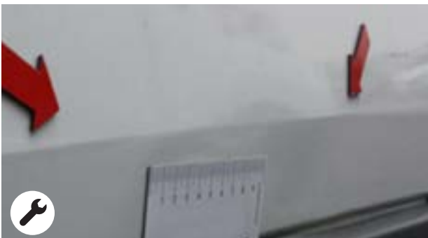
Mafaçon : Tôle déformée suite à une réparation
