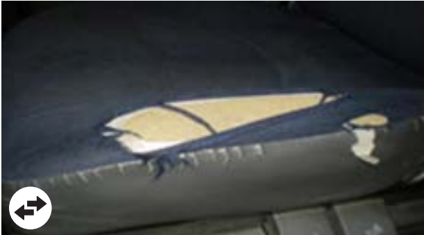
Brulure > 3 mm ou perforation ou déchirure de la coiffe sans détérioration de la mousse
