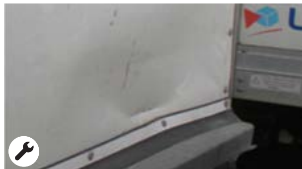
Portes latérales et arrières: déformation importante : temps de réparation > 1h dans la limite économique de la réparation, fermeture non étanche
