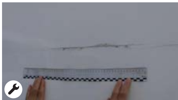
Panneaux latéraux: rayure avec arrachement de matière \geq 20cm dans la limite économique de la réparation. Possibilité de peinture en demi panneau
