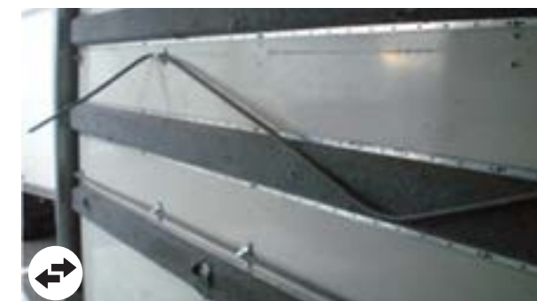
Capitons et tringles: tringles, fixations, capitons manquants ou déformés hors limite économique de la réparation
