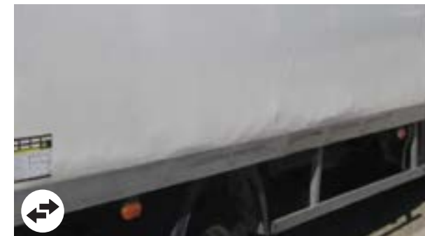
Panneaux latéraux fibre: déformation en partie basse sur une longueur > 1m NB : le remplacement du panneau de face avant de la caisse nécessite la dépose de la caisse.
