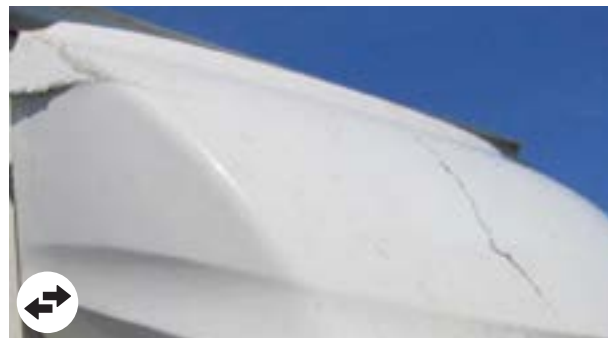
Capucine et déflecteur: fissure importante, morceau manquant ou hors limite économique de la réparation
