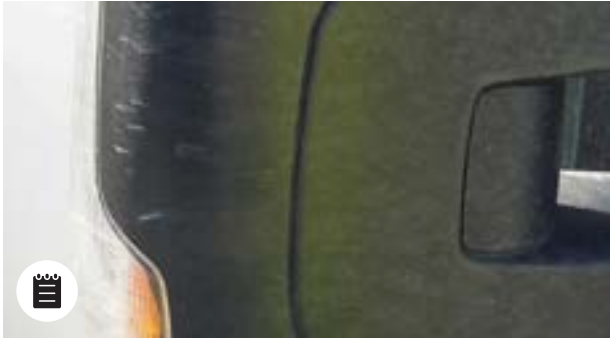
Rayures non sensibles à l'ongle et surface ≤ 45 cm² (équivalent à une carte de crédit)
