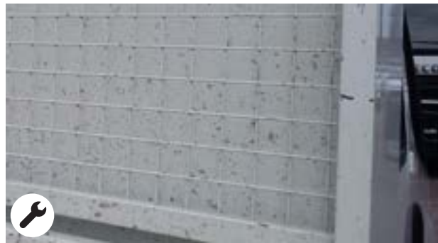
Trace de béton ou produit chimique dont la superficie ≥ ¼ de la superficie de la benne
